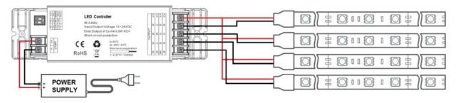
Application Circuit 2: CW+WW( V+→COMMON、CH1→CW、CH2→WW、CH3→CW, CH4: WW.)
