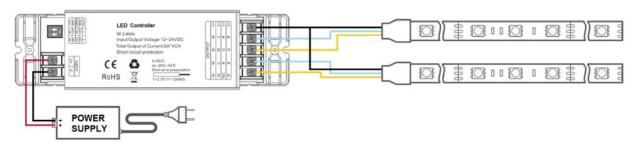
Application Circuit 3: RGB (V+→COM、CH1→R、CH2→G、CH3→B, CH4: NC.)
