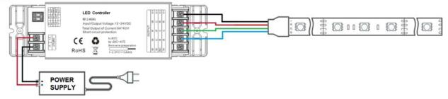
Application Circuit 4: RGBW ( V+→COM、CH1→R、CH2→G、CH3→B, CH4: W.)
